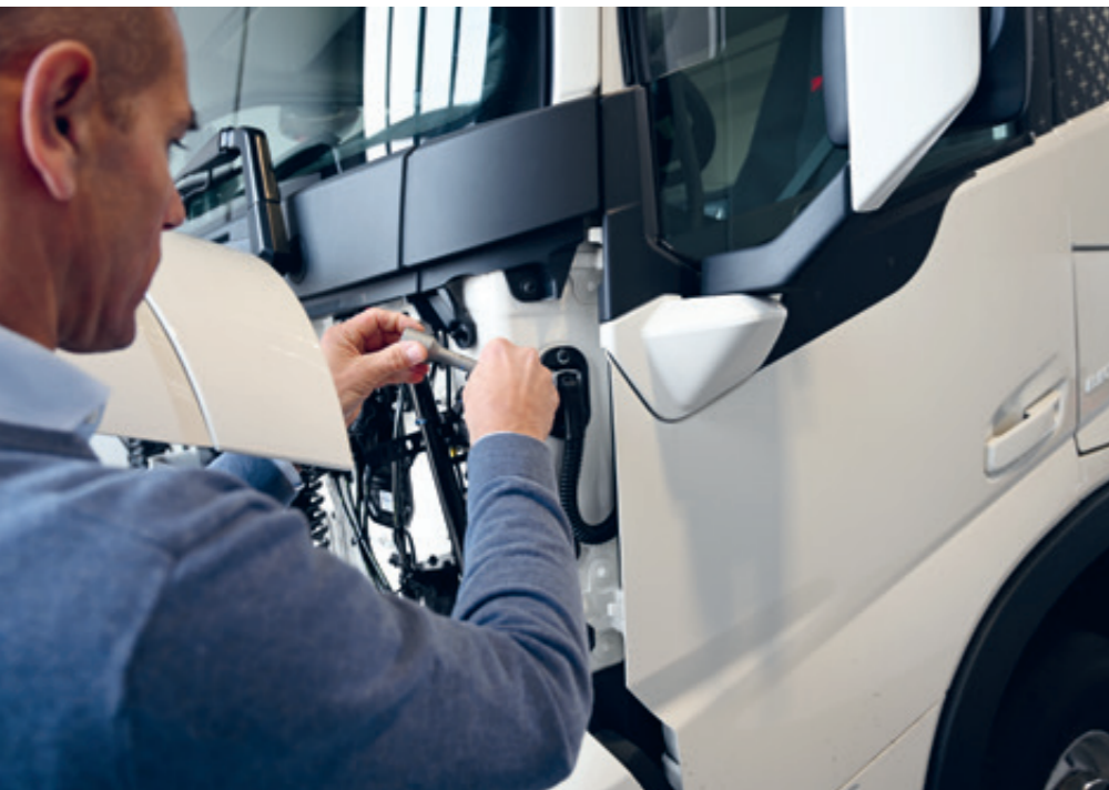
FLOTTER HANDGRIFF Werkzeugentnahme zum Kippen des Fahrerhauses.
