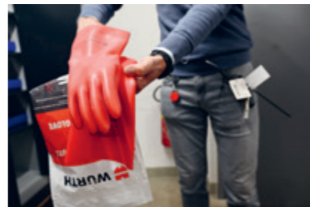
SPEZIELL Isolierender Elektro-Schutzhandschuh für Arbeiten am E-Lkw.
